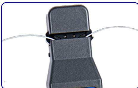
900µm紧套管光纤
